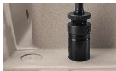
C - Procedere con il completamento del foro
