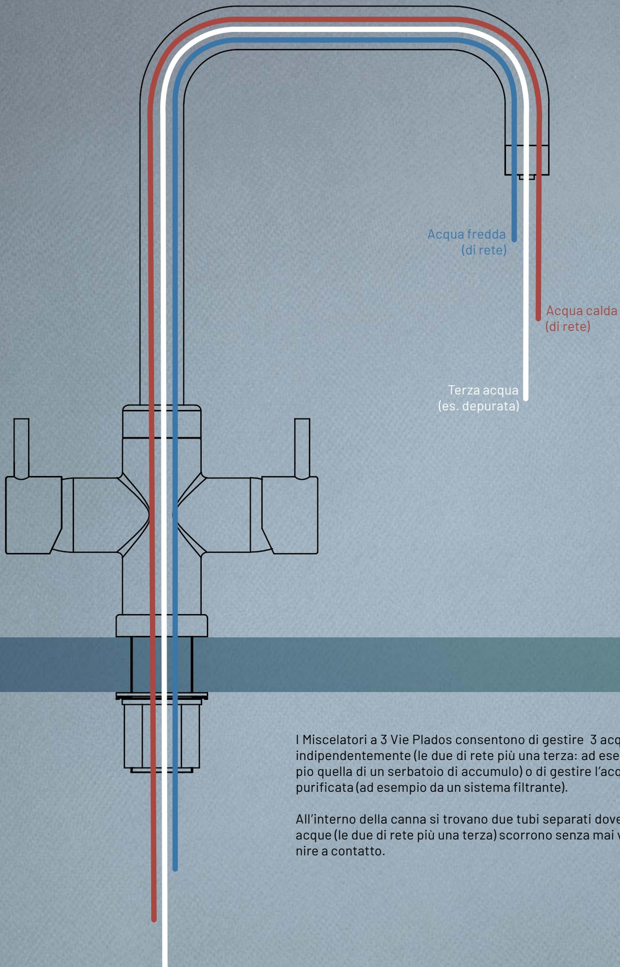
I Miscelatori a 3 Vie Plados consentono di gestire 3 acque indipendentemente (le due di rete più una terza: ad esempio quella di un serbatoio di accumulo) o di gestire l'acqua purificata (ad esempio da un sistema filtrante).
